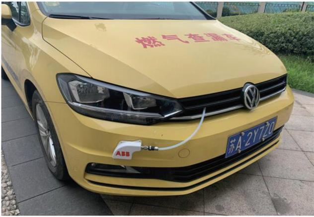
近日,细心的南京市民会看到一辆印有“燃气查漏车”字样的黄色轿车穿梭于街头巷尾。这是南京港华燃气有限公司新购进的全省首辆北斗高精度燃气泄漏检测车,管道有没有漏气“嗅一嗅”便知,150米范围内都逃不过它的“鼻子”。 赵冉 戴晓燕
