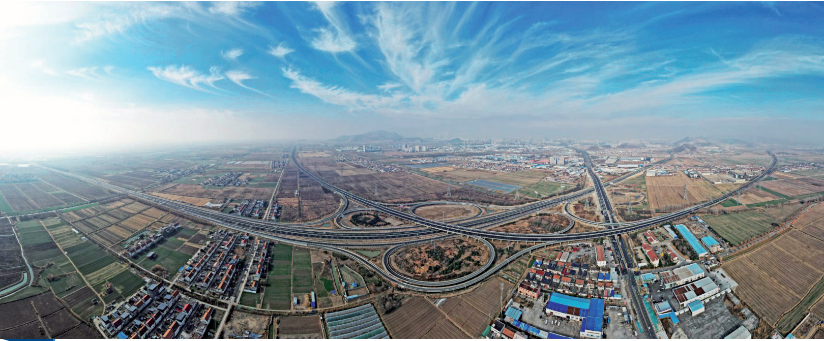
12月17日，长春至深圳国家高速公路连云港至淮安段改扩建工程通过交工验收，标志着苏北交通主动脉完成全面升级。该工程是长深高速(G25)重要组成路段，也是江苏省“十五射六纵十横”高速公路网的关键一环，起自连云港市海州区宁海枢纽北，止于淮安市淮阴区王兴枢纽北，全长98.6公里。该工程采用“两侧拓宽为主、局部分离为辅”的扩建方式，将原有双向四车道升级为双向八车道，设计时速提升至120公里。
