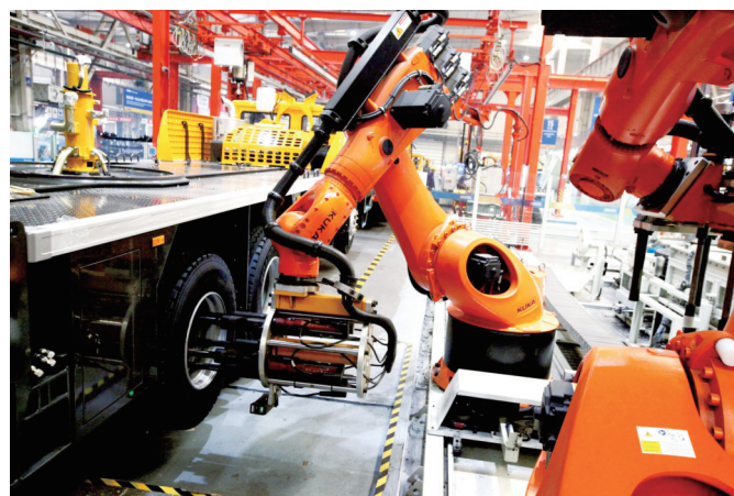
3月23日,在徐工重型中小吨位轮式起重机装配生产线上,关节机器人在安装轮胎。近年来,徐工集团全面推进“智改数转网联”,以科技创新塑造产业发展新优势。 荆创 摄
