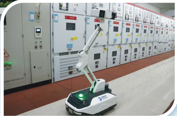
5G智能巡检机器人正有序巡检大屯公司姚桥煤矿主井35kV变电所
