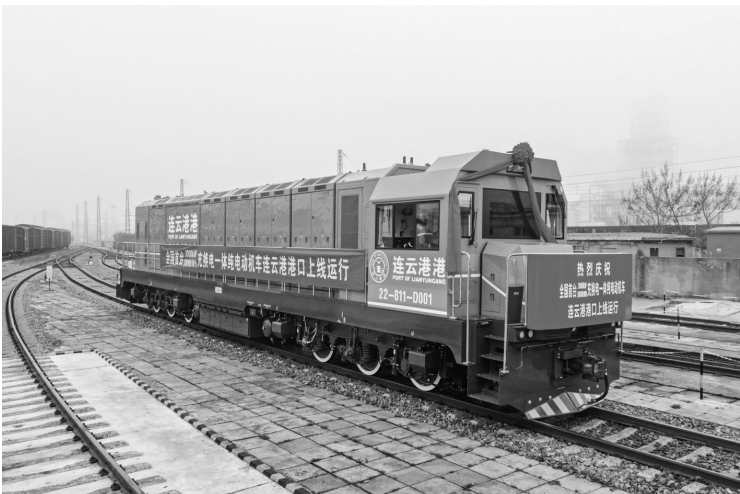
3月30日,全国首台3000kW充换电一体纯电动机车驶入连云港港口铁路编组场,正式投入运行。这是连云港港推动港口转型升级、加快智慧绿色港口建设取得的又一重大突破,也标志着连云港港口铁路运输装备进入“大功率、低能耗、零排放”的崭新阶段。
