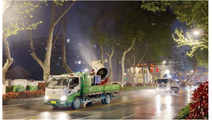
“吹冲扫”夜间物理除絮作业
