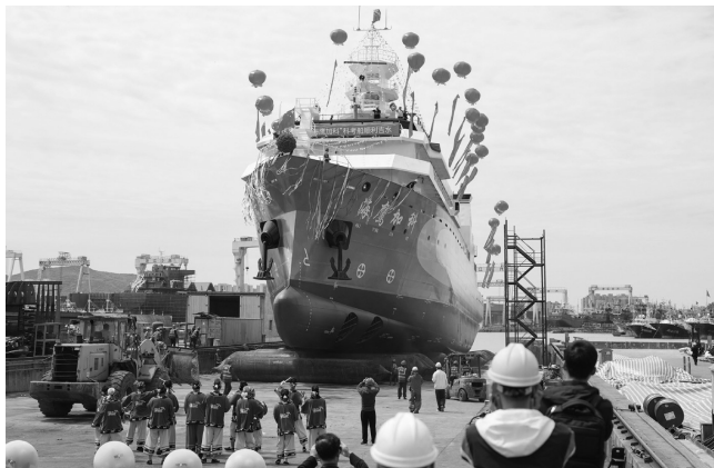
5月5日,中国首艘民营建造科考船“海鹰加科”号在浙江温岭市松门镇建成下水。这艘由民间资本投资约1.5亿元建造的科考船总长82米,计划满载排水量3500吨,续航力1万海里,自持力大于60天,具备在无限航区执行多学科综合考察的能力。它的投资者是37位浙江温岭渔民。 新华社发
