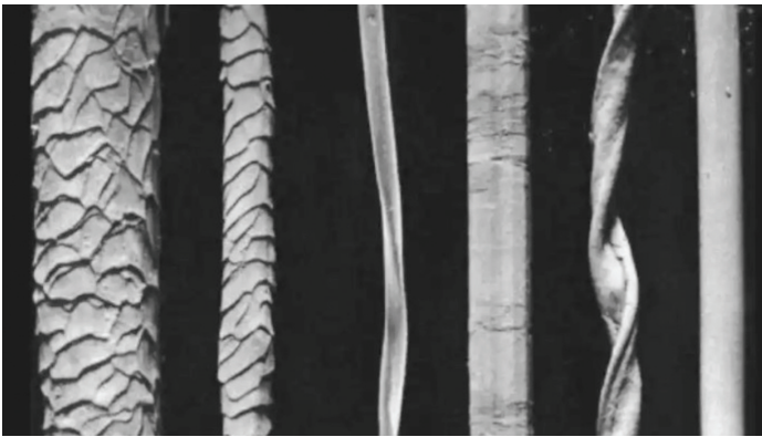
不同纤维的扫描电子显微镜显微照片,依次为:粗羊毛、细羊毛、丝绸、亚麻、棉花、聚酯纤维
