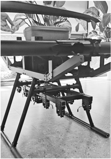
可带十发灭火弹的无人机
