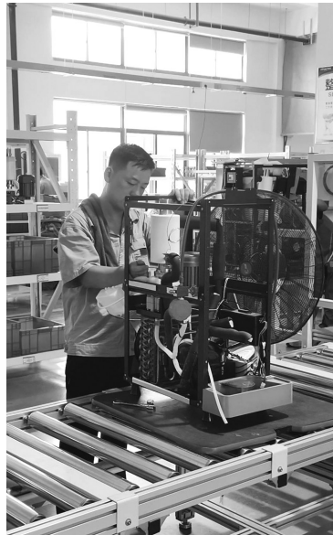
车间内工人正组装制冷模块
