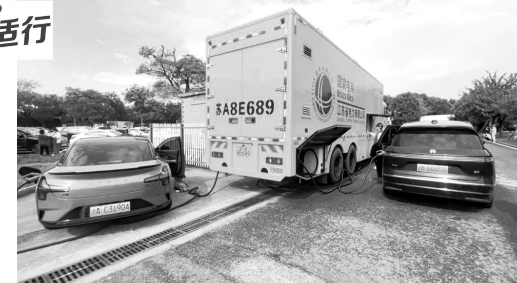
移动应急储能充电车正在给私家车充电
